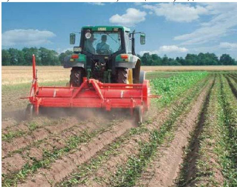
Рис. 1. Колея ходовой части трактора и ботвоуборочной машины БМК-4-75 при уборке картофельной ботвы с одновременным измельчением
