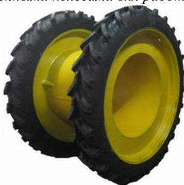
Рис. 5. Колесо с пневматическими шинами низкого и сверхнизкого давления
