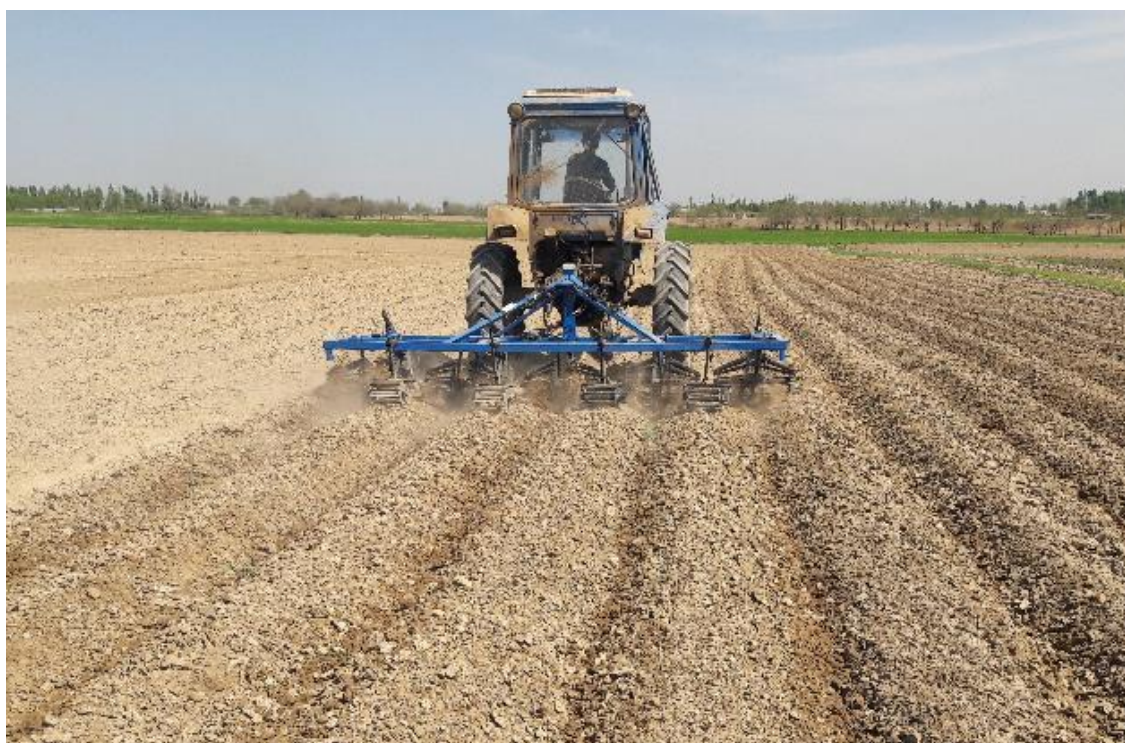
Рис. 2. Схема устройства для предпосевной обработки гребней
