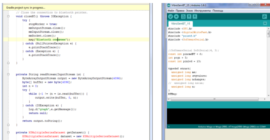
Рис. 7. Фрагмент программного кода устройства вибродиагностики на основе Bluetooth-модуля
