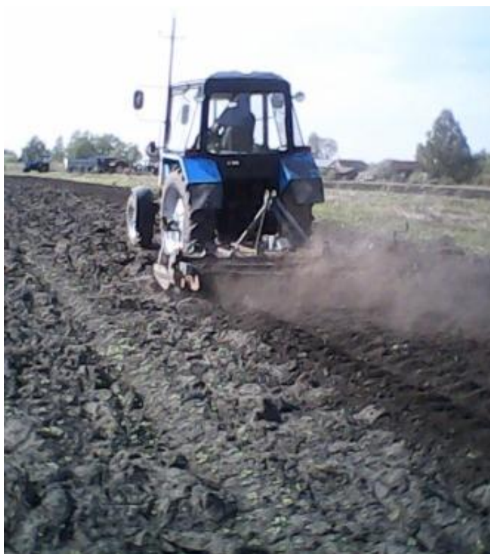
Рис. 2. Экспериментальный образец почвообрабатывающей машины с двухступенчатыми ножами F-образной формы
