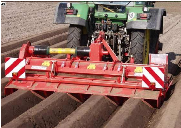
Рис.2. Применение колес узкой серии при работе агрегата в междурядьях
