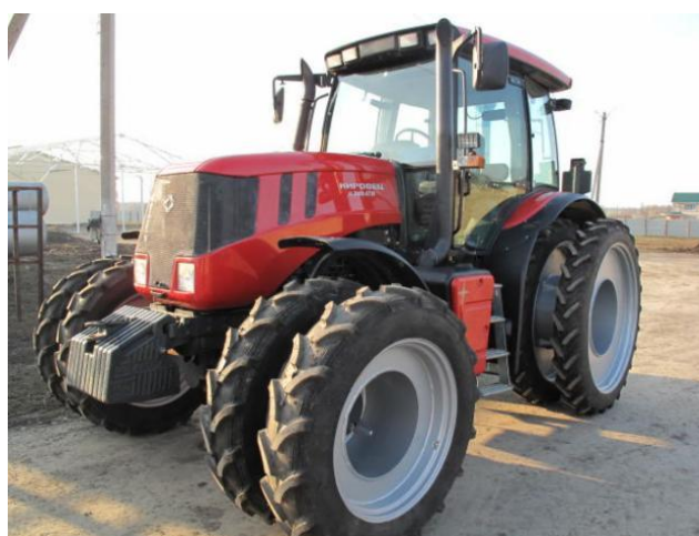
Рис. 3. Сдвоенные шины для работ в узких междурядьях от завода колесных систем «Консима»
