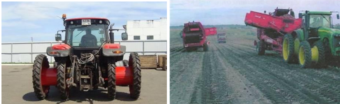
Рис.4. Трактор МТЗ со сдвоенными колесами для работы при обработке картофеля
