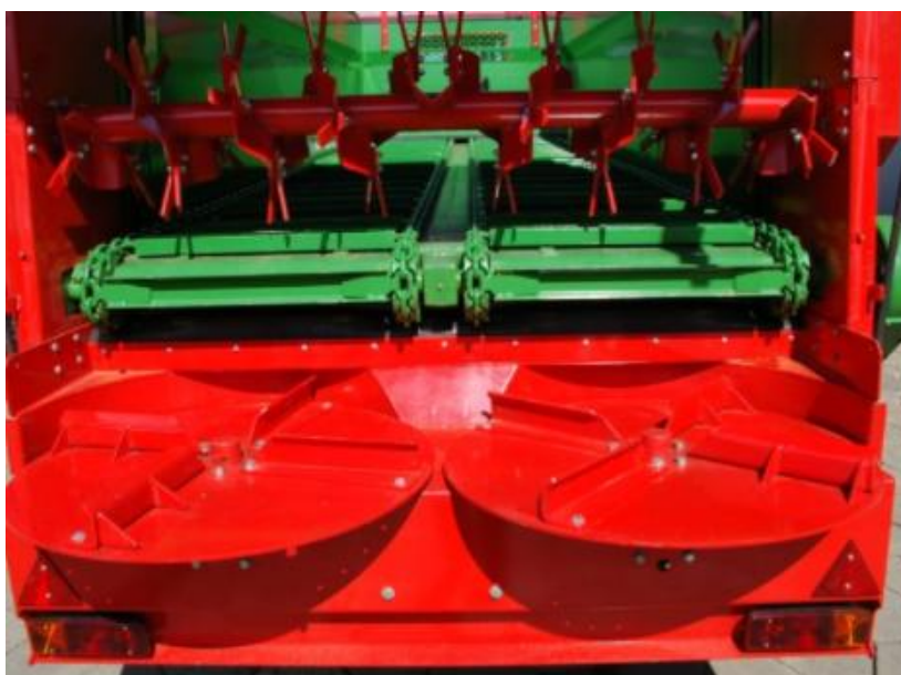
Рис. 4. Конструкция распределения удобрений разбрасывателя PRONAR N262/1
